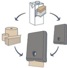
Grâce à un **procédé exclusif** et mécanique, Lucart parvient à séparer les matériaux des briques alimentaires afin de les recycler totalement. Les fibres de cellulose, dont la qualité est similaire à de la pure ouate, deviennent le **Fiberpack®**, dont sont faits les produits d'essuyage EcoNatural. L'aluminium et le polyéthylène deviennent l'**Al.Pe.®**, utilisé notamment pour fabriquer les appareils EcoNatural Flow.
